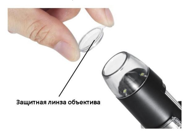
Защитная линза объектива: в верхней части объектива микроскопа имеется защитная крышка объектива, пожалуйста, снимите её перед началом использования устройства. В противном случае это повлияет на качество изображения. Закрывайте объектив линзой после использования, чтобы предохранить его от загрязнения.
